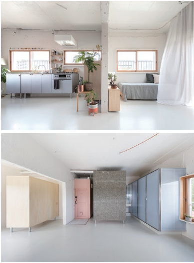
台と家 | 2020年 | 写真=中山保寛 ———— 都内で築50年ほどの団地の一室を購入し、リノベーションしたふたりの自宅。約30㎡と狭小ながら、間仕切り壁と天井を取り払い、床面も極力下げて、天井高2.9mの広々とした空間に改変。バスルームやトイレ、キッチンそれぞれ足元を浮かせたつくりで、全体のワンルームのなかにボックスが点在するような構成になっている。一部可動式のキッチンは、令和3年度キッチン空間アイデアコンテストで協会会長賞を受賞。2022年度グッドデザイン賞。
